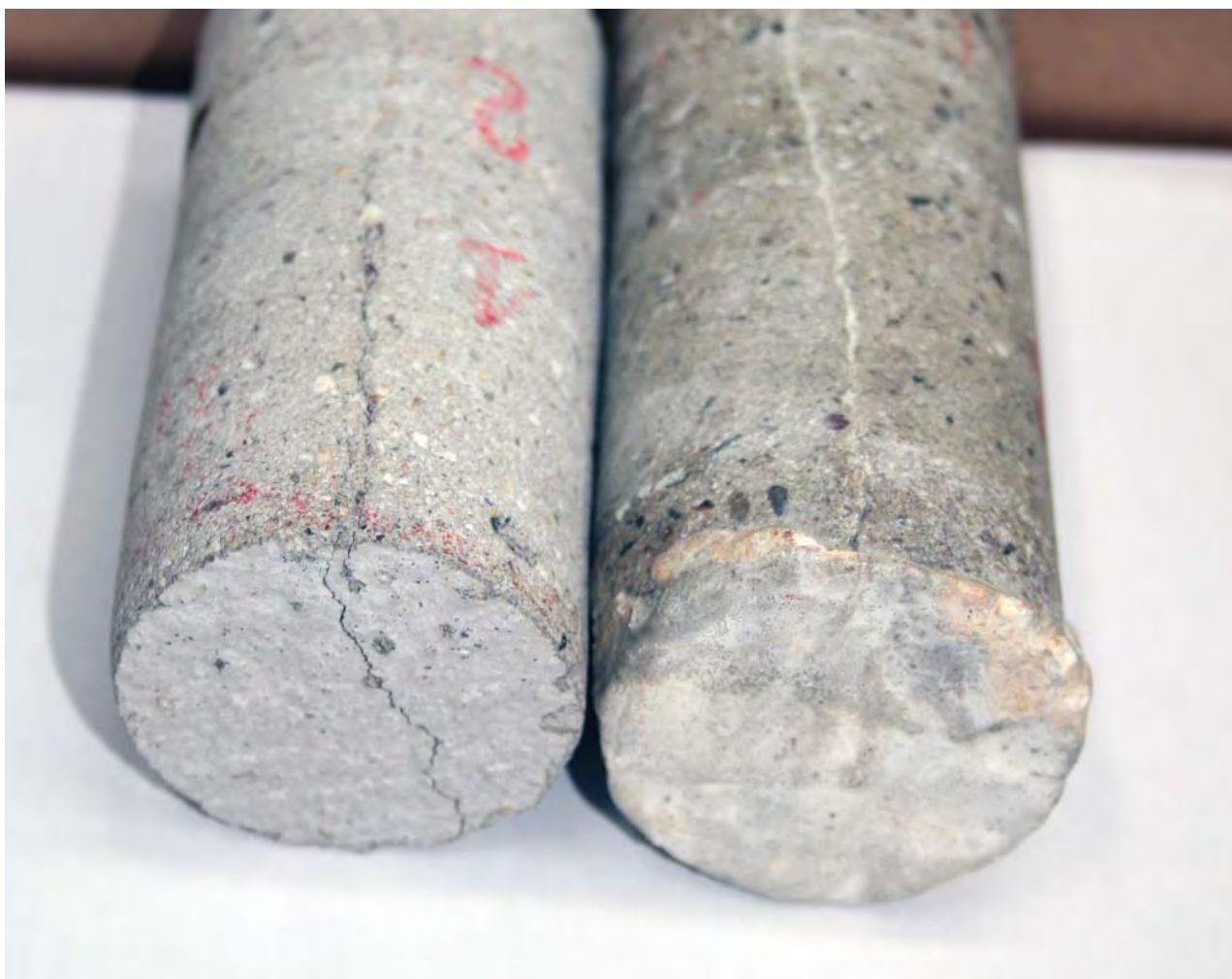
a sinistra: carota in cls non trattata a destra: carota di cls trattata con Penetron® Standard
