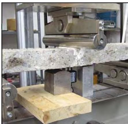
Fig. 1 - Setup prova di flessione su tre punti
