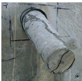
Photo 1) Echantillons d'évaluation avec carottages de la matrice en béton des structures enterrées sous nappe marine du Terminal 3 de l'aéroport de Singapour Photo 2) Présence de cristaux de différentes formes et dimensions le long d'une fissure : ils scellent complètement la craquelure (cristaux C-S-H, silicate de calcium hydraté) Photo 3) Agrandissement « BEI » (backscattered electron image) qui illustre la croissance cristalline à l'intérieur d'une microfissure Photo 4) Détail ultérieurement agrandi de l'image « BEI », qui illustre les typologies de cristaux : minces et oblongs, fins et en forme d'aiguilles.
