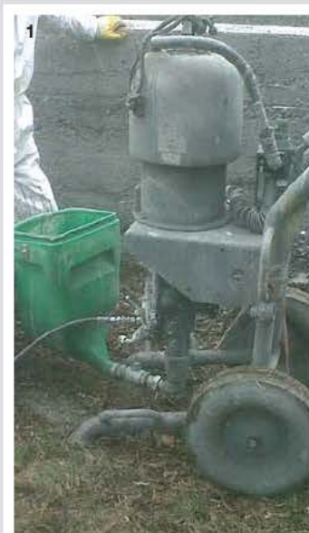
Photo 1) Mélange du Penetron Inject, bicomposant, dans une pompe à coulis cimentaire fluide prévue à cet effet - Photo 2) Préparation des packers à injection et injection du coulis visqueux sous pression - Photo 3) Le Penetron Inject peut être utilisé en association à des résines polyuréthaniques hydro-expansives élastiques - Photo 4) Réaction cristalline de scellement dans une fissuration
