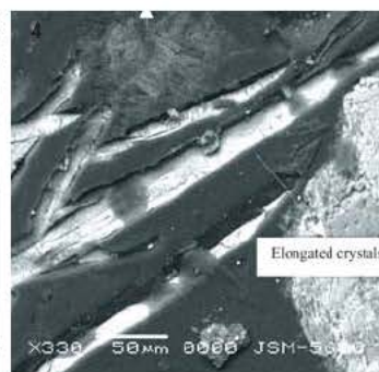
Photo 1) Echantillons d'évaluation avec carottages de la matrice en béton des structures enterrées sous nappe marine du Terminal 3 de l'aéroport de Singapour Photo 2) Présence de cristaux de différentes formes et dimensions le long d'une fissure : ils scellent complètement la craquelure (cristaux C-S-H, silicate de calcium hydraté) Photo 3) Agrandissement « BEI » (backscattered electron image) qui illustre la croissance cristalline à l'intérieur d'une microfissure Photo 4) Détail ultérieurement agrandi de l'image « BEI », qui illustre les typologies de cristaux : minces et oblongs, fins et en forme d'aiguilles.
